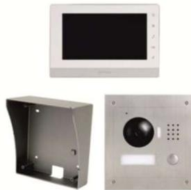
El **KIT videoportero IP POE** integra una **cámara ip** con sensor de imagen 1/3" **1.3 Megapixel** CMOS con una lente fija de 2.8 mm. Esta cámara permite un **ángulo de visión de 90 en horizontal y 120 grados en vertical** que proporciona una imagen en color detallada de la persona que llama al videoportero.
