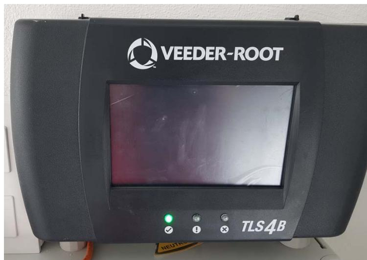
Foto nº 11. Consola Veeder Root a instalar en la caseta de control
