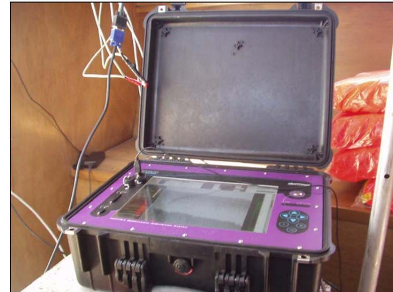
Fotografía 32: Registro del perfilador a 3,5 kHz.
